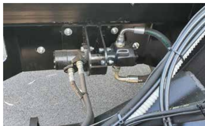
Ribaltamento con motore idraulico e pompa
