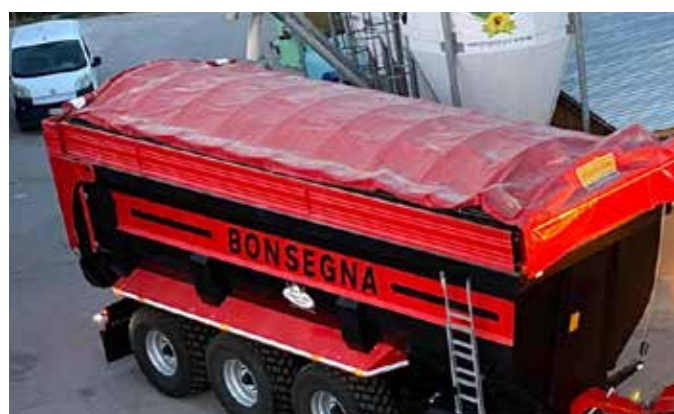
Telone di copertura
